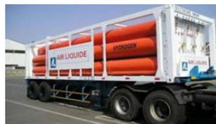
3000M<sup>3</sup> (250kg) 氫拖車台的停車空間需要5mx15mL，調換拖車時的旋轉空間，至少要維持兩部拖車及迴轉的空間，拖車間的間隔需要1.85m，因此必須保留12mx15m的停車空間(60m<sup>2</sup>)。
